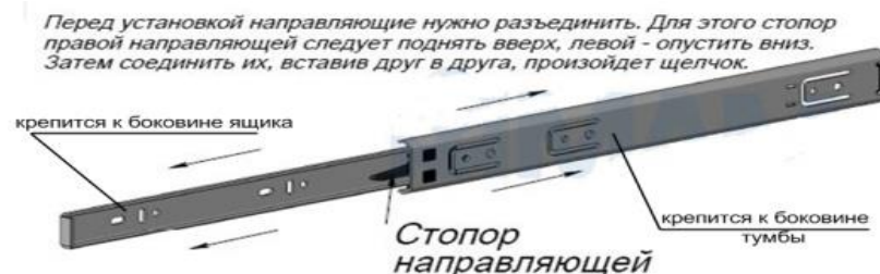
Рис.4 Схема установки шариковых направляющих
