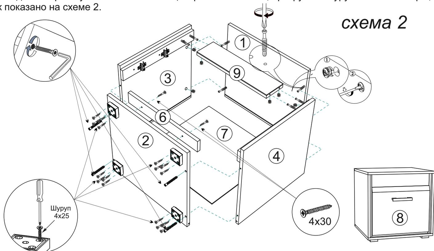
4. Установите тумбу на место. Закрепите петли на створке. Створка №8 крепится к планке №5 прикрепленной к боковине №3. установите ручку шурупами 3,5x30. Зазоры отрегулируйте по схеме приведенной выше.
